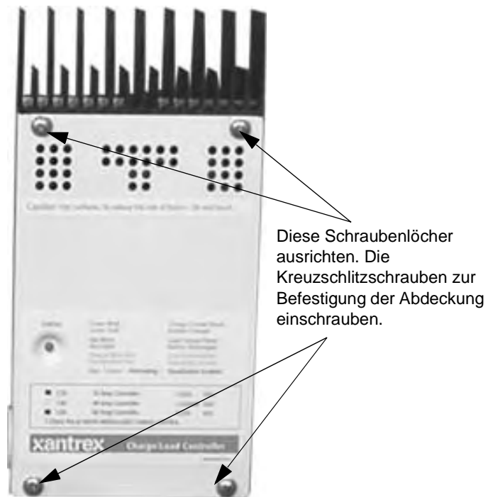
Abbildung 2-28 Wiederanbringen der CM Abdeckung
