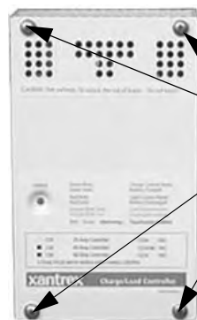
Abbildung 2-1 Abnehmen der Frontabdeckung
